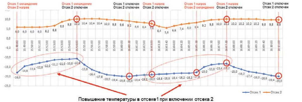
4 Заданная температура: отсек 1: -20 °С, отсек 2: +10 °С
