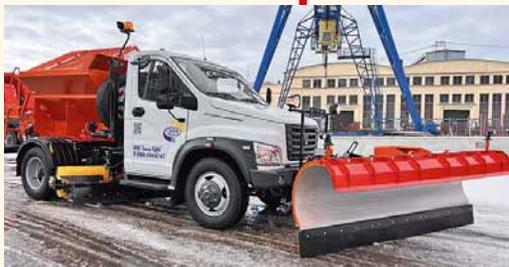
149 л. с. Вместимость топливного бака – 105 л. Габариты КДМ в комплектации с поворотным отвалом и пескоразбрасывающим оборудованием – 9000x2800x2920 мм, при этом ширина обработки – от 2420 до 2800 мм в зависимости от угла наклона отвала.
