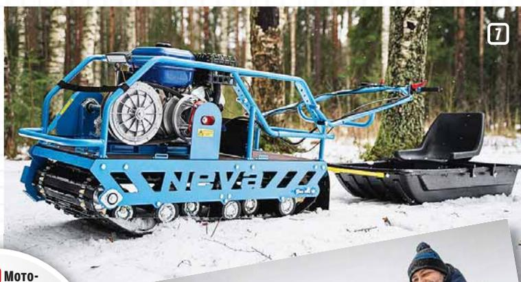
вой гамме, а воздушный циклонный фильтр адаптирован к работе техники в условиях большой запыленности, и такой фильтр можно чистить. С учетом круглогодичной эксплуатации мототехники в Российской Федерации, в спецификации двигателей Zongshen для «Мототехника «Нева» используются карбюраторы с облегченным низкотемпературным запуском, а в моделях GB270 и выше применяется праймер для подкачки топлива.
