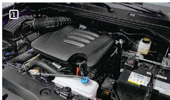
**1** Турбодизель 2.0 серии GW4D20M для России дефорсировали со 163 до 150 сил. Тягу в 400 «ньютонов» сохранили. К мотору прикручен 8-ступенчатый автомат ZF. За полный привод отвечает электрогидравлическая муфта BorgWarner.
