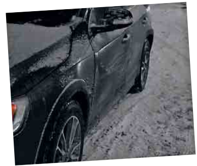
После сильного удара в левую бочину V60 сохранил как траекторию движения, так и целостность кузова.
