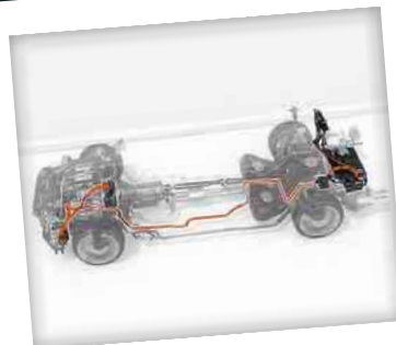
Так схематично выглядит высоковольтная часть Porsche Panamera S E-Hybrid.
