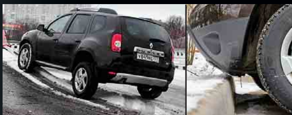
RENAULT DUSTER без отрыва колес проехал дальше всех на 25 см и продолжал ползти. Угол заезда самый большой, хотя бампер самый низкий – всего 19 см.
