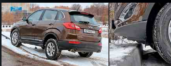
CHERY TIGGO 5. Подвеска здесь столь же короткоходна. Бампер хоть и сильно выпирает, зато просвет под ним самый большой – около 25 см.
