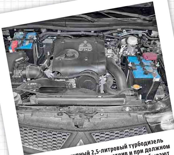
Единственно доступный 2,5-литровый турбодизель (136 л. с., 314 Нм) вполне неприхотлив и при должном присмотре служит очень и очень долго. Хотя бывают и капризы: например, из-за слетевшей с турбины трубки может пропасть тяга.
