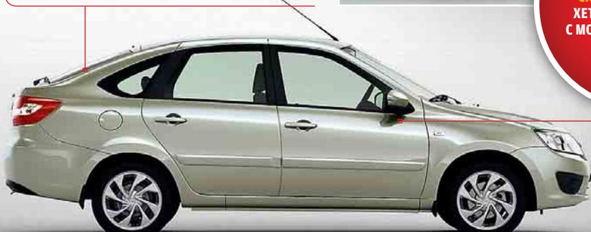
**СИЛОВОЙ КАРКАС** кузова хетчбэка остался таким же, как у седана, но форма задней части была скорректирована. Новинка получила иные задние двери, глухие форточки большего размера и более покатую крышу, плавно переходящую в пятую дверь.
