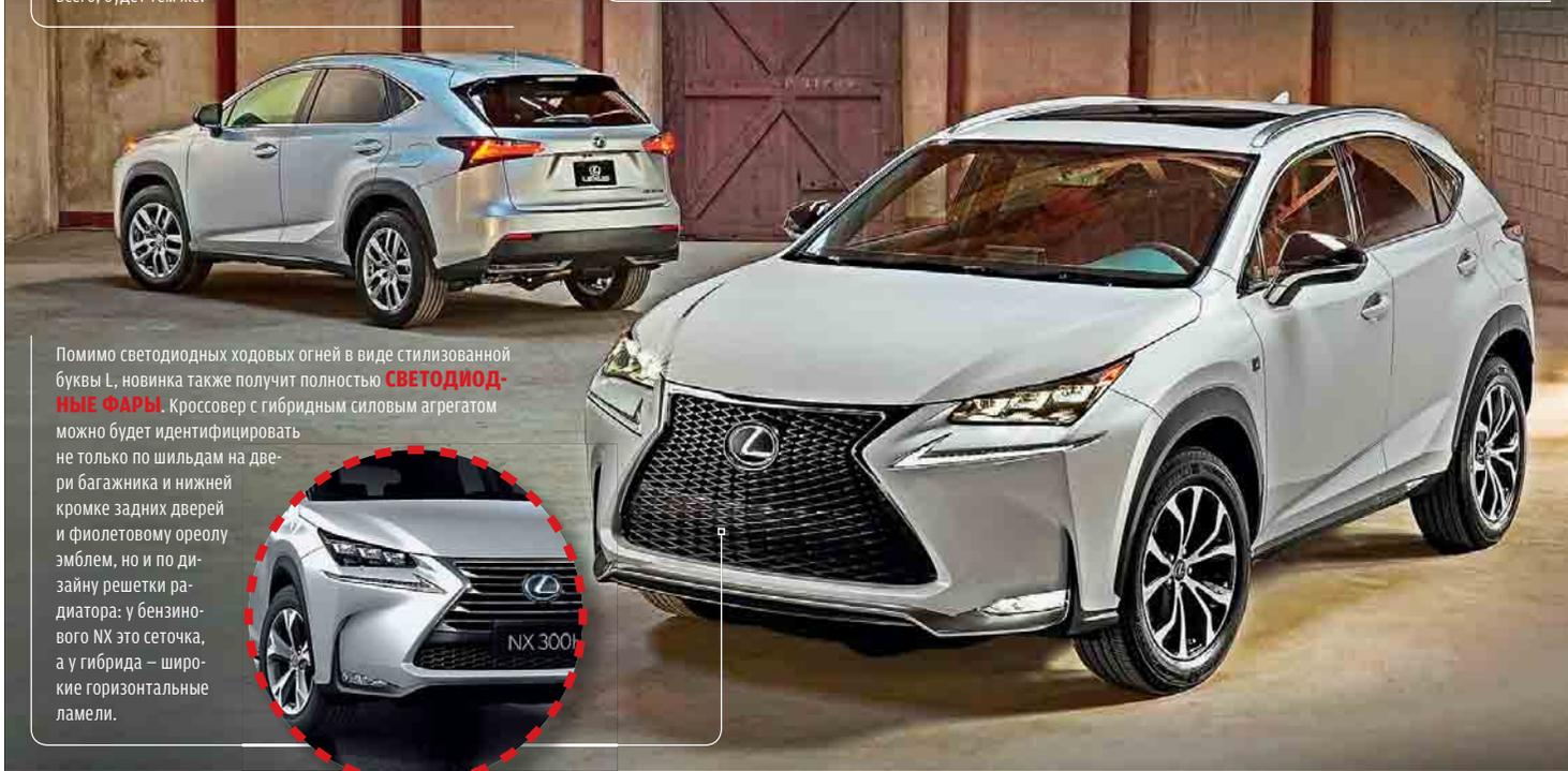
Помимо светодиодных ходовых огней в виде стилизованной буквы L, новинка также получит полностью **СВЕТОДИОДНЫЕ ФАРЫ**. Кроссовер с гибридным силовым агрегатом можно будет идентифицировать не только по шильдам на двери багажника и нижней кромке задних дверей и фиолетовому орлеу эмблем, но и по дизайну решетки радиатора: у бензинового NX это сеточка, а у гибрида – широкие горизонтальные ламели.
