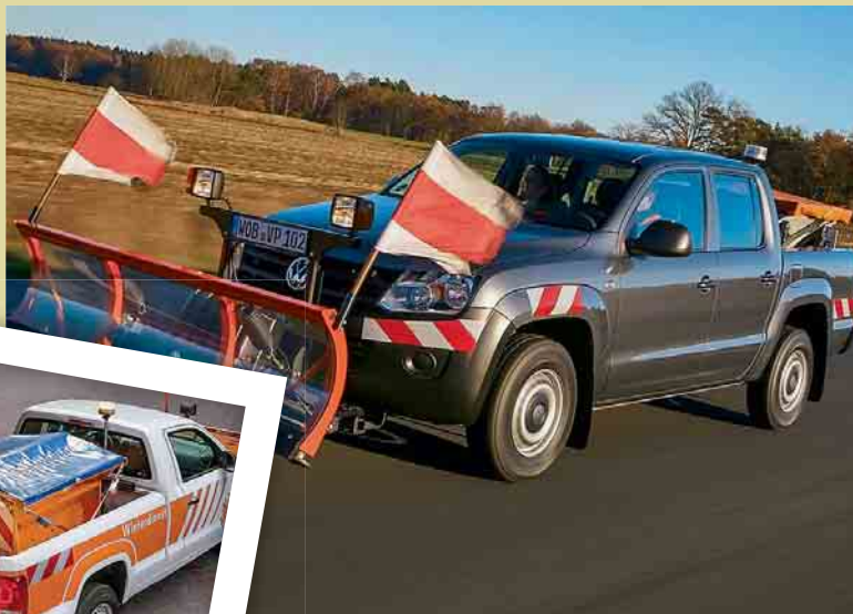
В кузове пикапа может быть установлен разбрасывающий агрегат, который вмещает до 0,5 м 3 соли.
