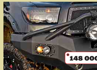
Силовой передний бампер (вес в сборе 88 кг)
