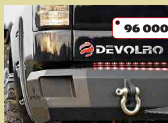
Силовой задний бампер (вес в сборе 55 кг)
