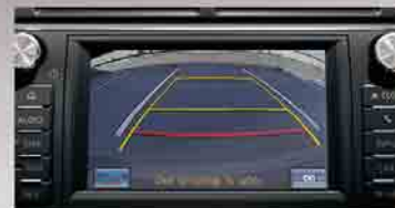
Камера заднего вида с динамической разметкой
