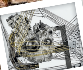
Концепт 3-цилиндрового двигателя Yamaha с крестообразным коленвалом.
