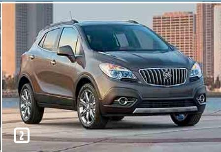
крупных BMW X1 или Audi Q3! А ведь еще можно сложить сиденья... Оснащение модели — не хуже, чем у старших братьев. В «базе» — система стабилизации, 10 эйрбэгов, 18-дюймовые литые диски, аудиосистема с 7-дюймовым цветным дисплеем и 6-ступенчатый автомат. Мотор покупателям Encore доступен только один — «опелевский» турбированный Ecotec объемом 1,4 литра, развивающий 140 л. с. и 200 Нм (в диапазоне 1850–4900 мин<sup>-1</sup>) со стандартно передним или опционно полным приводом. □
